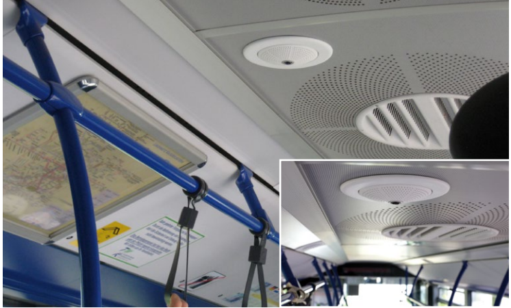
Q25M im Deckeneinbau-Set (Nahverkehrsbus)
